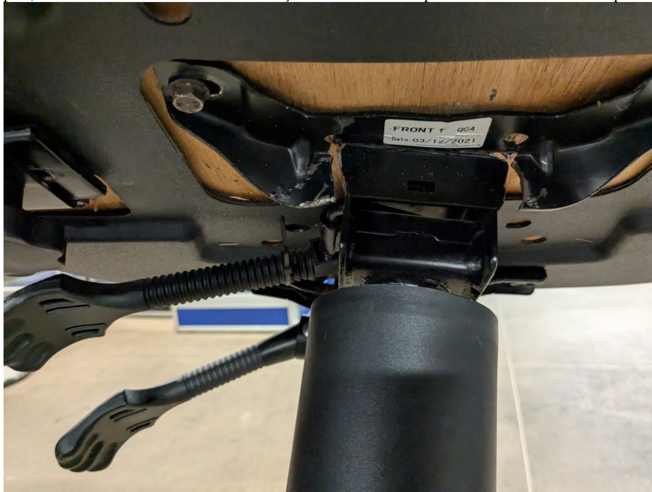
Figura 1: ilustrando madeira trincada e aço quebrado.
