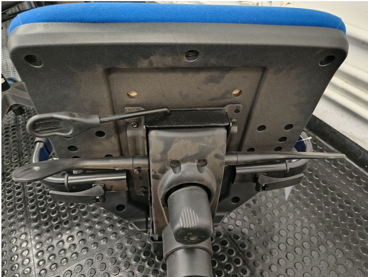
Figura 2: excesso de alavancas, o que causa confusão, e carenagem com furações sem acabamento, que lembra queijo suíço.
