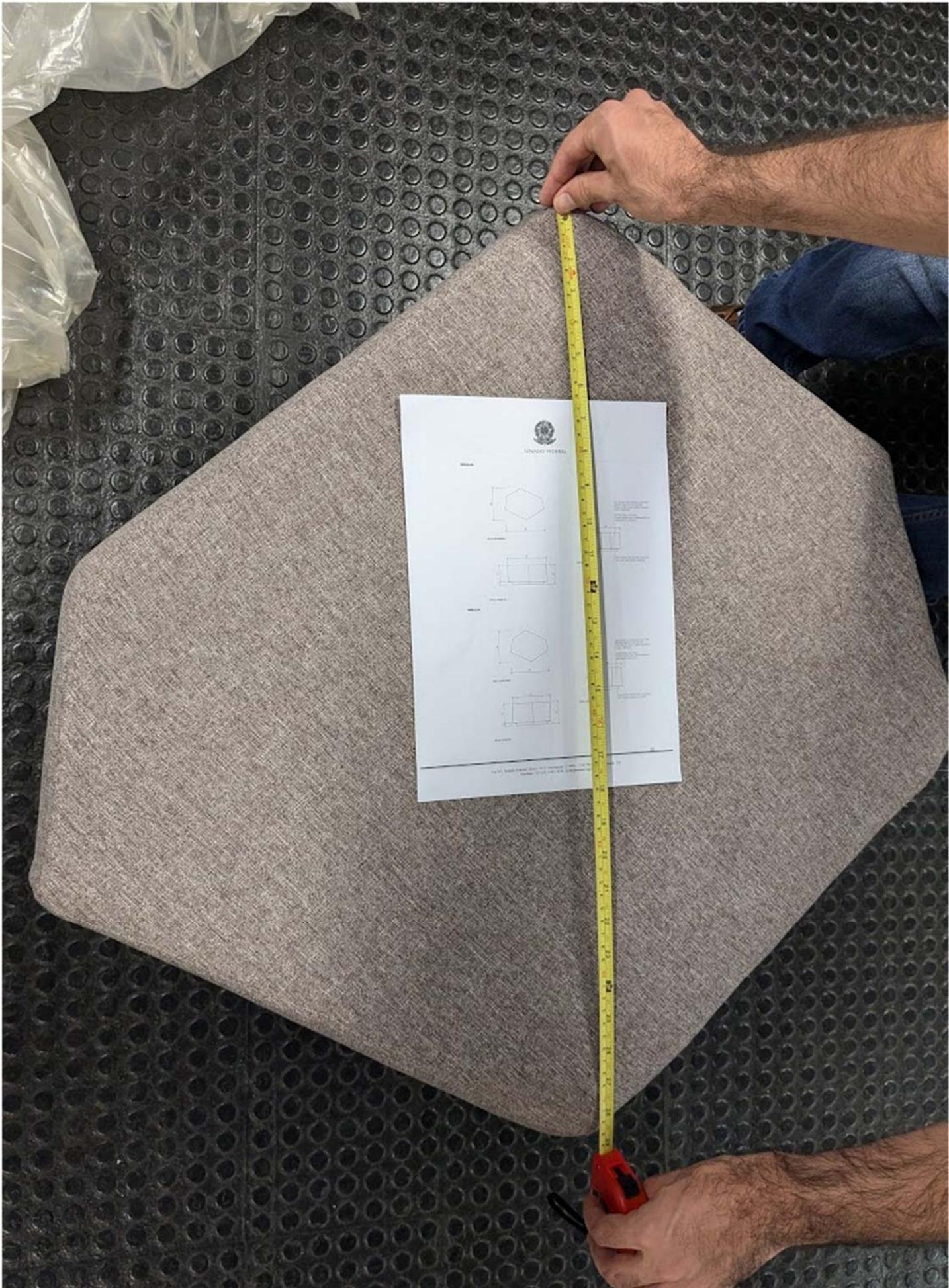
Em suma, a amostra não possui o formato nem as dimensões exigidas. Em combinação, esses dois pontos inviabilizam a montagem do conjunto de forma harmoniosa, por isso a proposta é rejeitada.
