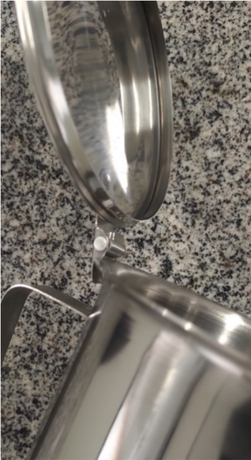
Rebarbas em toda e extensão da parte de baixo da tampa.
