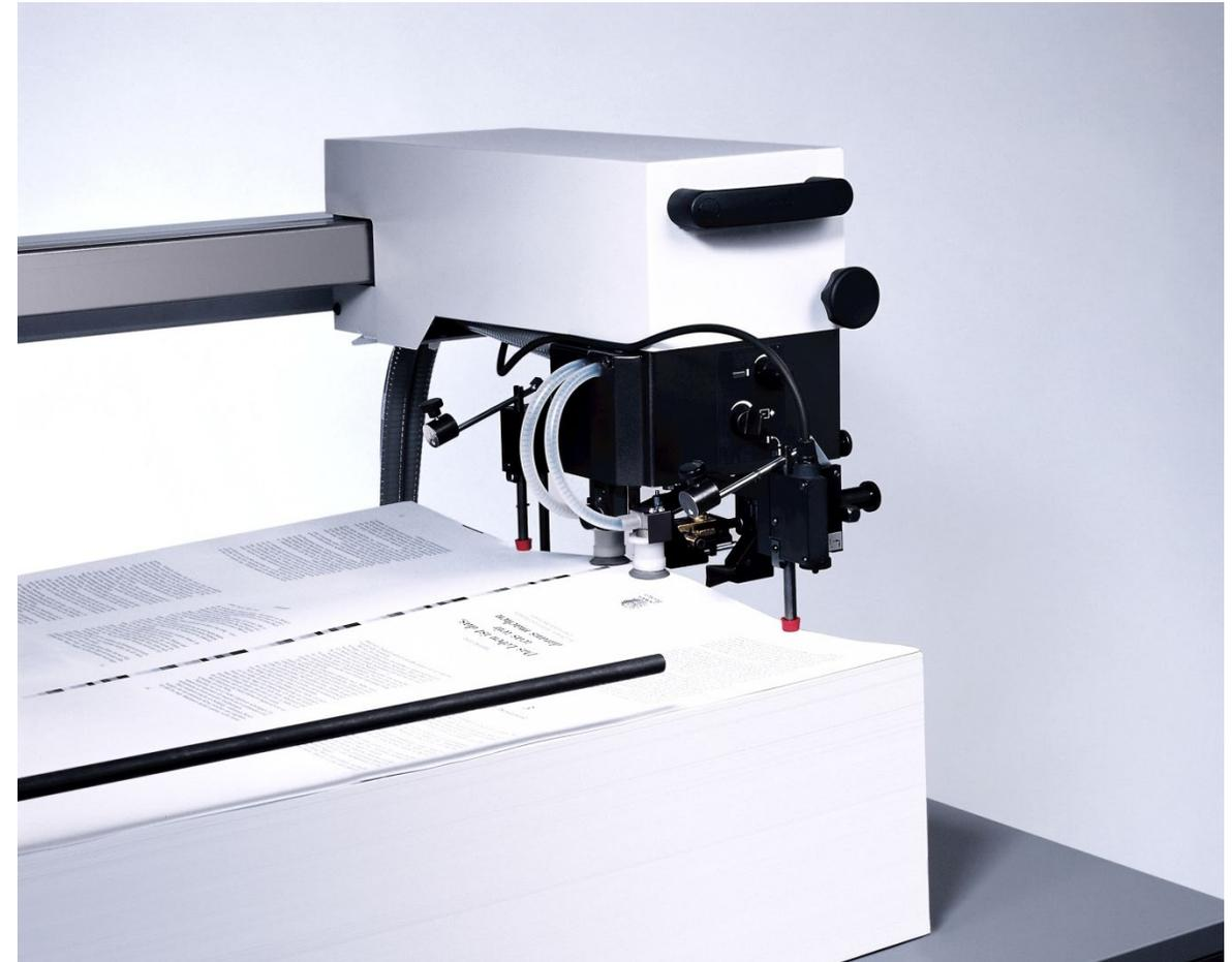
Belüftung und Separation der Bogen am
