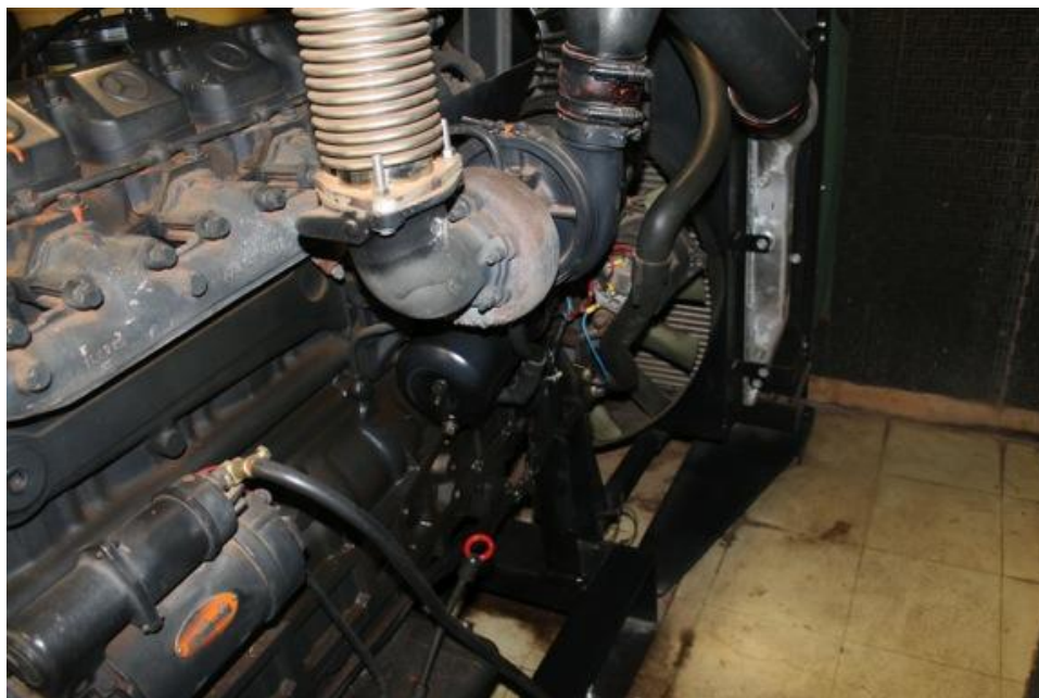
Foto 80: Detalhe lateral do motor. Nota-se o motor de partida (canto inferior esquerdo da foto), e o turbo-compressor.
