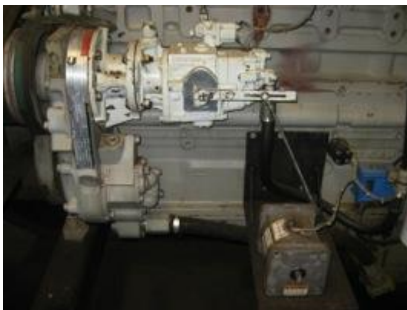
Foto 54: Detalhe da bomba injetora, do acelerador, e do atuador.
