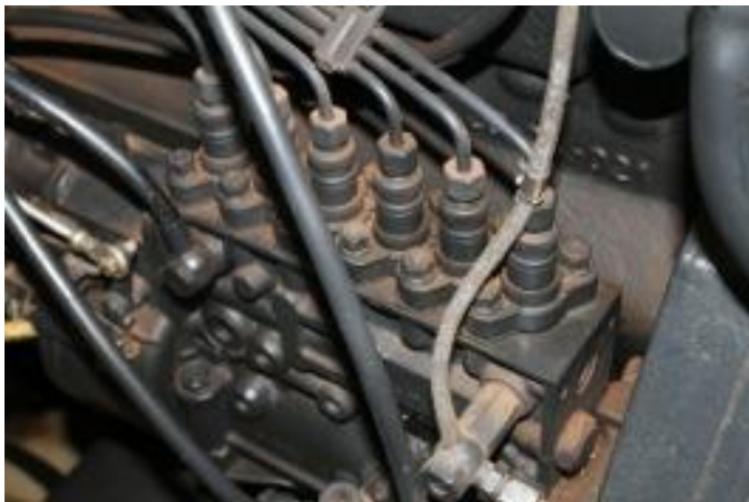
Foto 82: Detalhe do sistema de alimentação do motor, mostrando a bomba injetora.
