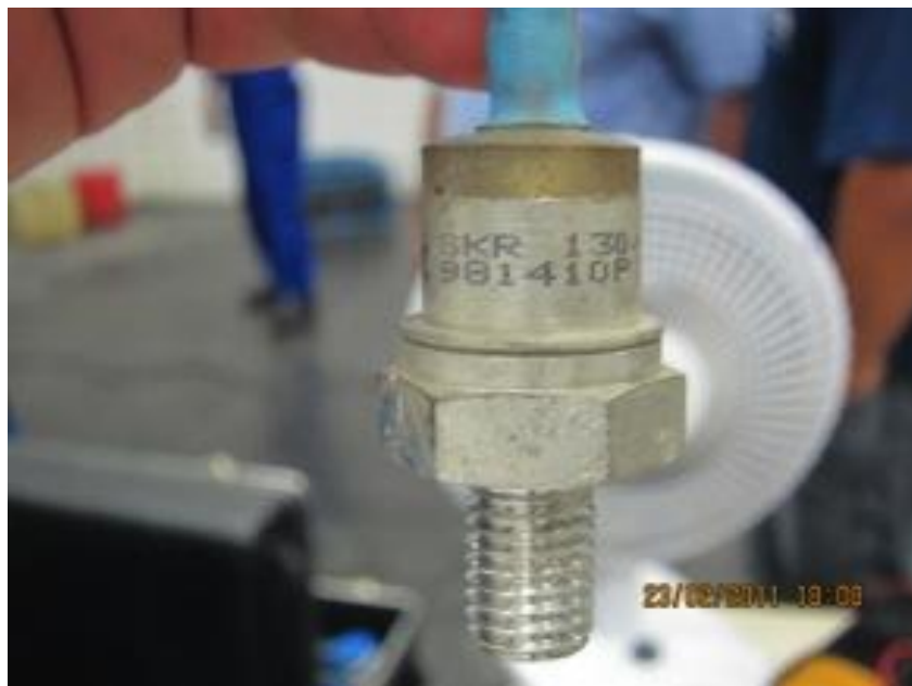
Foto 21: Detalhe de um diodo retificador da ponte girante do rotor (SKR 130/12)
