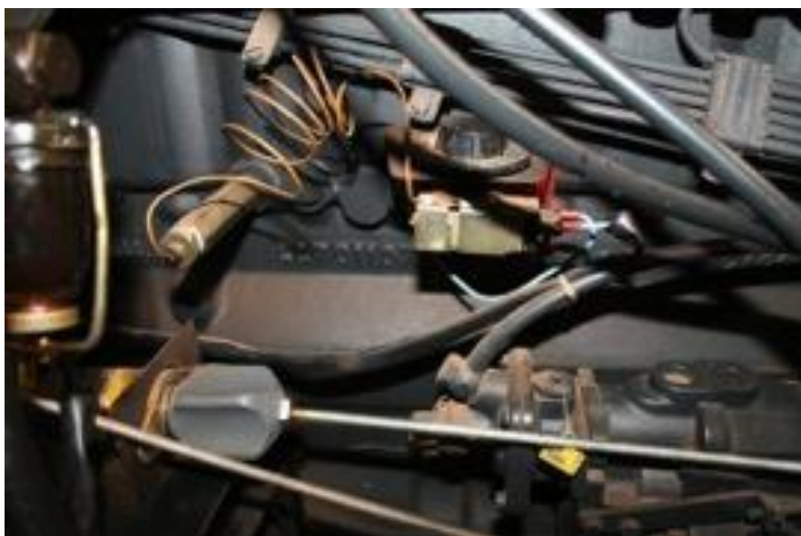
Foto 83: Detalhe da lateral do motor, mostrando o termostato.
