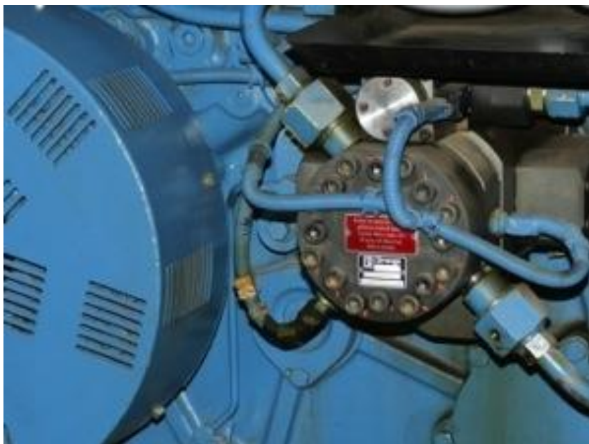
Foto 13: Detalhe da bomba de combustível de alta pressão (L'Orange) de um motor diesel MTU.
