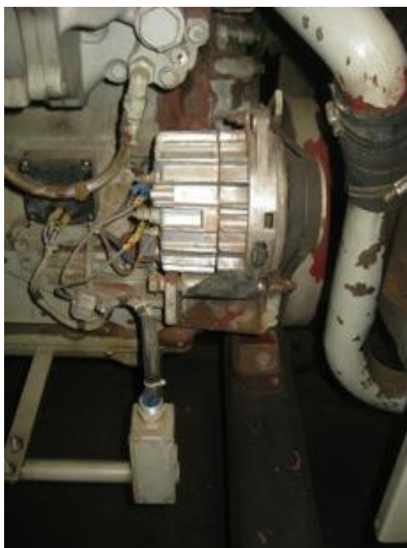
Foto 60: Detalhe do alternador e das correias.
