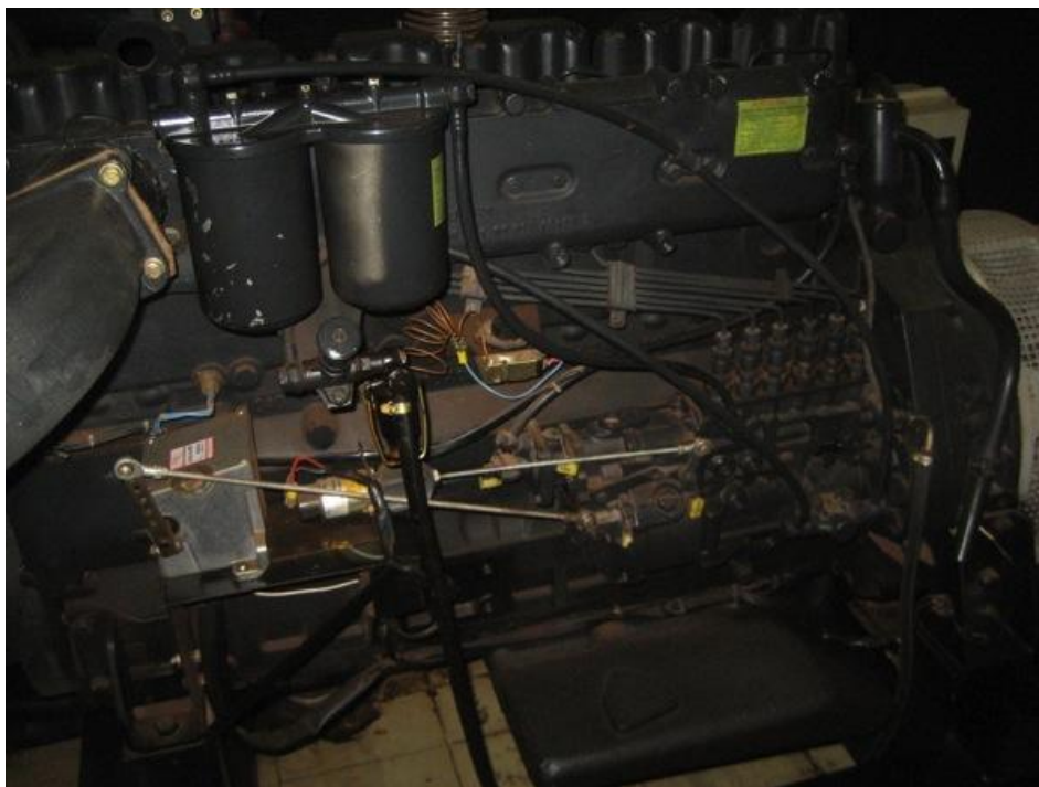
Foto 76: Visão lateral do motor. Notam-se os filtros de combustível, as linhas de combustível, o atuador e a solenóide.
