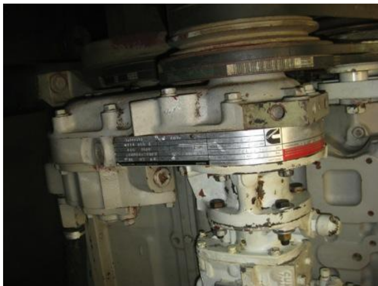
Foto 69: Placa de um motor. A placa contém as seguintes informações, entre outras: Motor No. 30117317, Modelo NTTA 855 G, Pot Dec 465 HP a 1800 RPM, Config N°. D093402DX02, Data Fabr 10 05 84, SO N°. 6019, Código Tempo Injeção AM, Torque do Injetor 5/6 pol-lbs, Curso do Injetor TS Folga Zero pol, Folga Valv. Fria 0 11 Adm 0 23 Esc, Vazão Comb. a Pot Dec 270 mm3/ciclo, Fabricado pela Cummins Brasil S.A. O bloco do motor tem a marca “Big Cam”.
