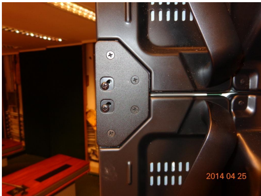
Figura 5 - Dispositivos metálicos de travamento lateral
