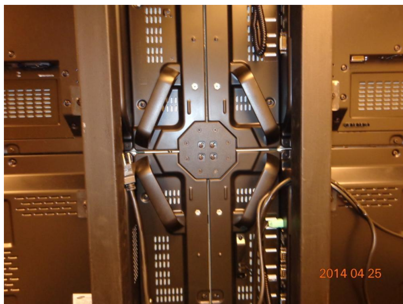
Figura 6 - Dispositivos metálicos de travamento central
