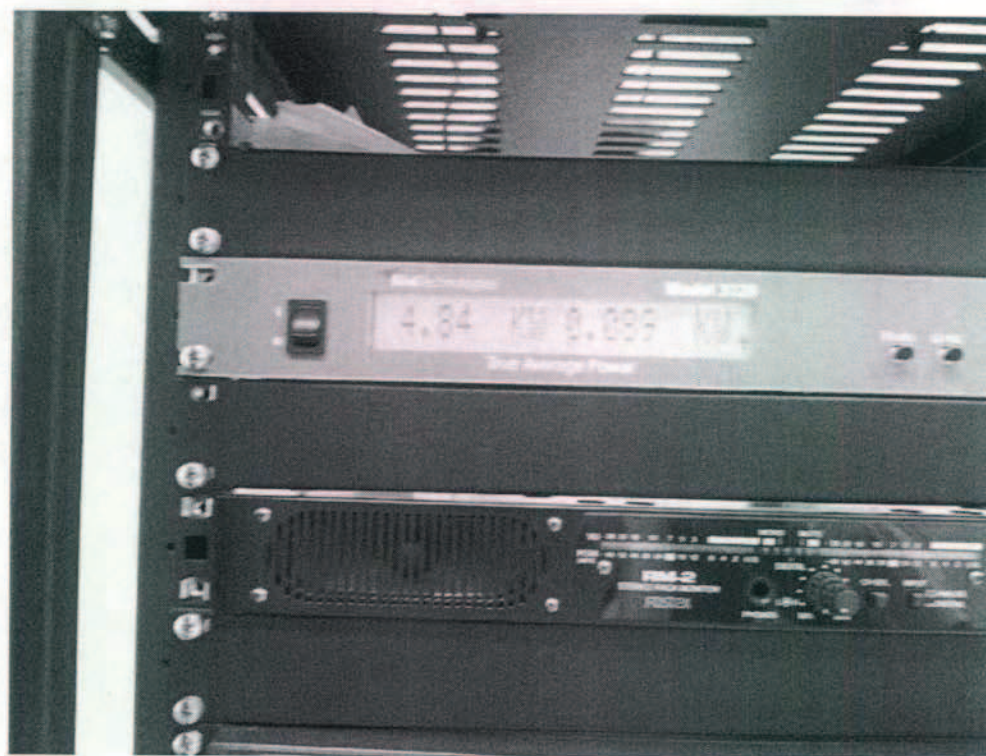
Foto 7 – Medidor de potência indicando a potência de transmissão e da refletida:
