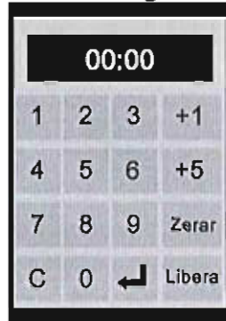
Figura 7 - Leiaute para controle de som integrado ao console do Presidente
