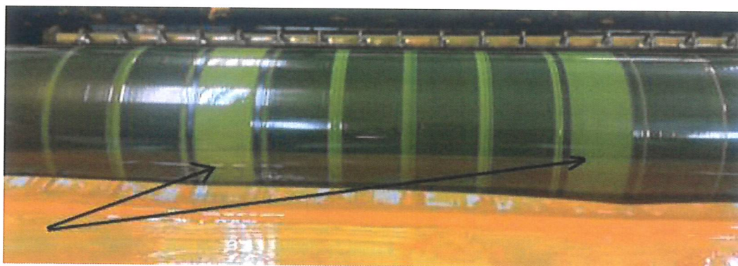
Foto 14: Motor de registro do tinteiro não está funcionando
